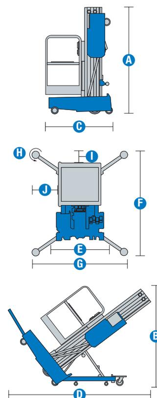
(1) O equivalente métrico da altura de trabalho acrescenta 2 m à altura da plataforma. A altura da plataforma é aumentada em 6 pés (1,82 m) nos EUA.
